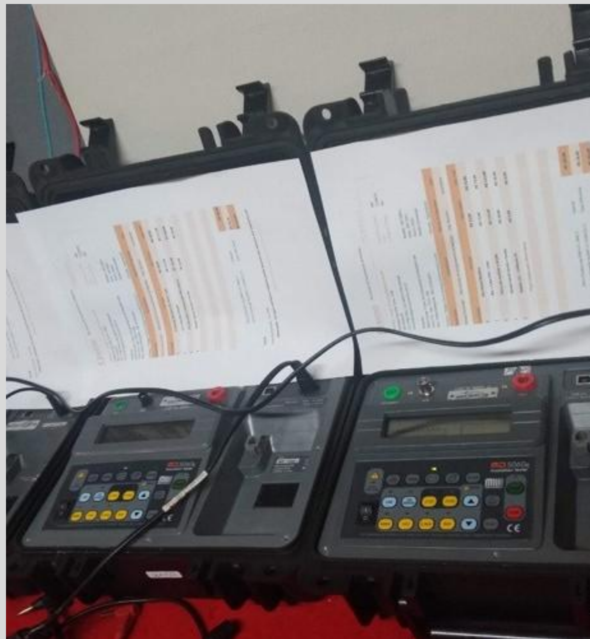
teste de isolamento em motores - Bridgestone
